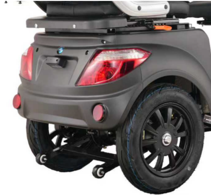
Figuur 1.11 Schematische voorstelling van anti-kantel-/steunwielen
